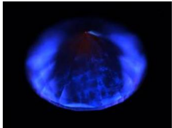
「フィルターなし」の画像：青色蛍光を示す CVD 合成ダイヤモンド
