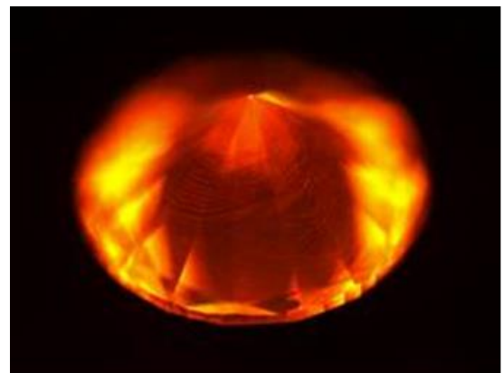
「0フィルターの装着」の画像：CVD合成特有の成長縞がみられる
